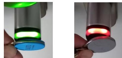
Leuchtet der Zylinderknopf rot, so müssen Sie mit dem Chip an den Haupteingang und **Schritt 1** wiederholen.
